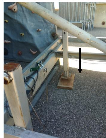
Insérer les axes, verrouiller avec les goupilles, tirer le frein à main et descendre les chandelles.
