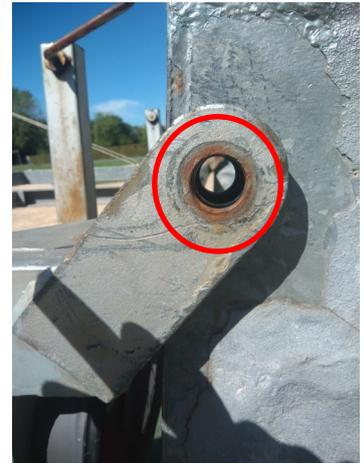
Placer la remorque dans l'axe du mur, puis monter l'avant de la remorque via la roue jockey (afin d'en abaisser l'arrière) pour aligner les trous du mur et de la remorque (il peut être nécessaire d'avancer/reculer légèrement).
