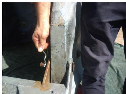
Retirer les goupilles et les axes du mur; il est nécessaire de « jouer » avec la roue jockey et/ou d'avancer/reculer légèrement la remorque afin que ceux-ci se libèrent plus facilement.
