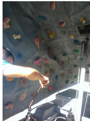
Basculer la manette et commencer à pomper pour actionner le vérin et lever le mur.
